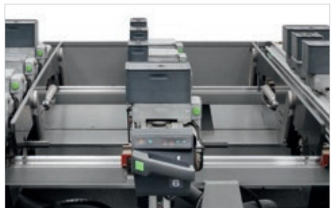
**SA (Set Up Assistance)** permite un posicionamiento manual sencillo, rápido y controlado de los sistemas de sujeción. Los sensores lineales de la mesa de trabajo y la función de control de colisiones reducen el riesgo de colisiones.
