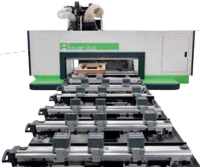
Rover AS 15 con estructura Gantry, ha sido calculado para soportar elevados esfuerzos de mecanización garantizando la calidad del producto terminado.
