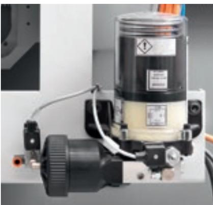
Lubricación automática cabezal de taladro BHZ 29 2L.
