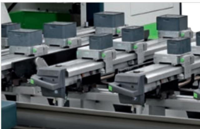
**ATS (Advanced Table-Setting System)** permite un posicionamiento manual rápido y sencillo de los sistemas de sujeción.
